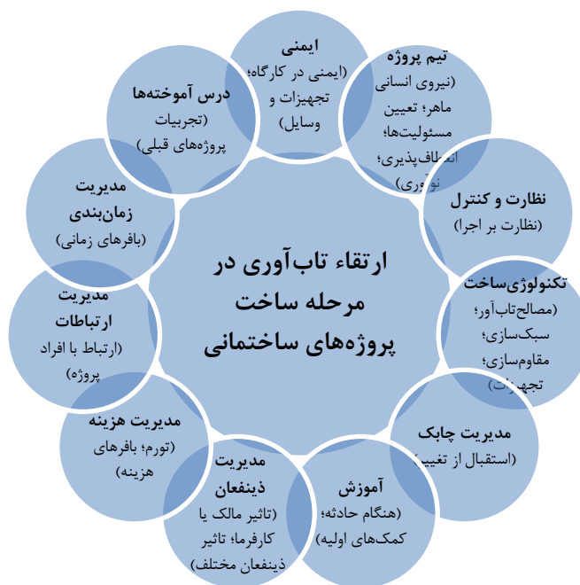
شکل ۱: مدل مفهومی ارتقاء تاب‌آوری در مرحله ساخت پروژه‌های ساختمانی به‌منظور کاهش آسیب‌ها و شکست‌های ناشی از حوادث و اختلالات
